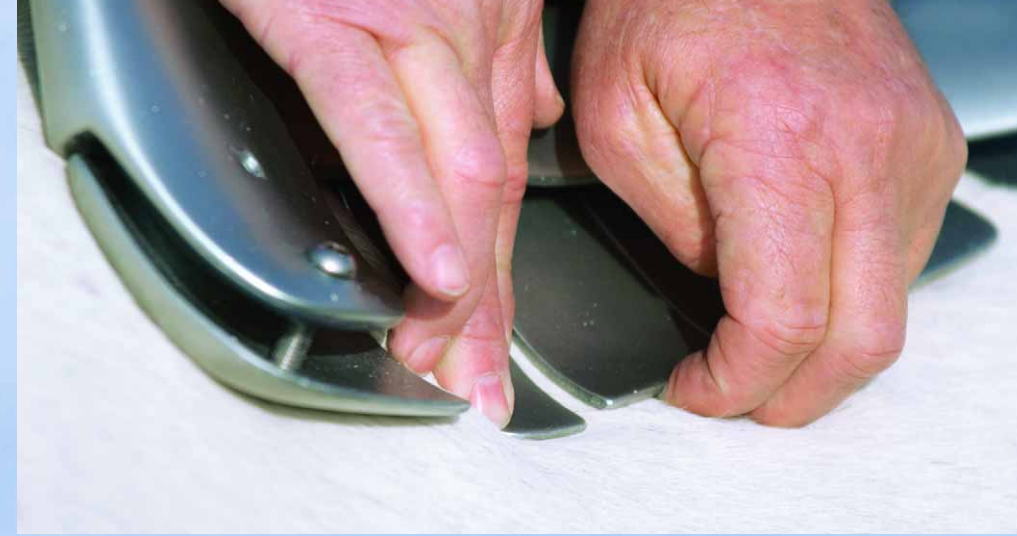
Stoßdämpfer: Die biegsamen Dämpfungsarme des Baums puffern jede Druckänderung ab. Je länger die Schlitze, desto größer die Dämpfung.
